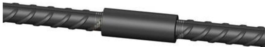
Le giunzioni a manicotto sono state previste prevalentemente **per i getti di seconda fase dei varchi lasciati in fase di costruzione**, dove la giunzione delle barre per sovrapposizione sarebbe stata tecnicamente infattibile.
