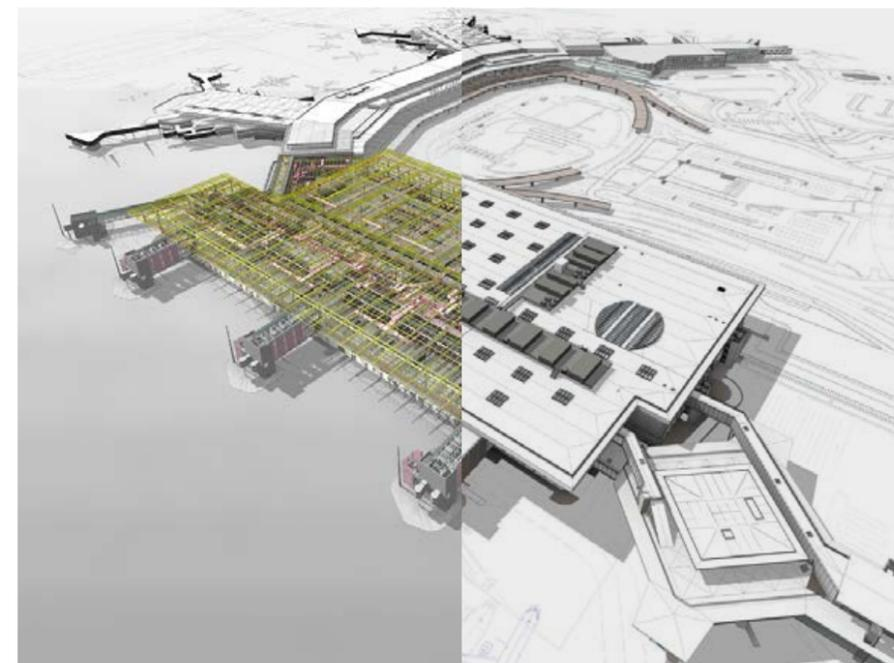
▲ *Sovrapposizione del modello BIM strutturale/impiantistico con quello architettonico*
