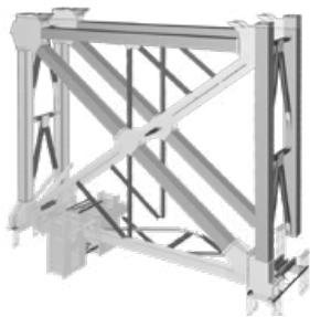
▲ Base Portale: modellazione FEM particolare costruttivo.
