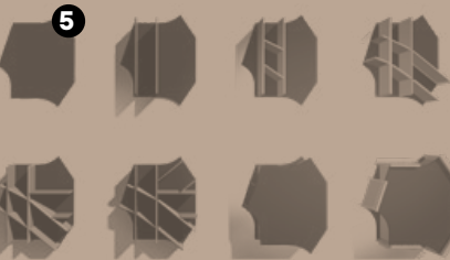
▲ Fasi di montaggio di una colonna del portale principale. Assembly stages of a main portal column.
